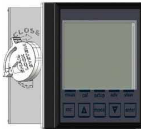
图1 - pH/ORP及温度测量挂墙式安装仪表
